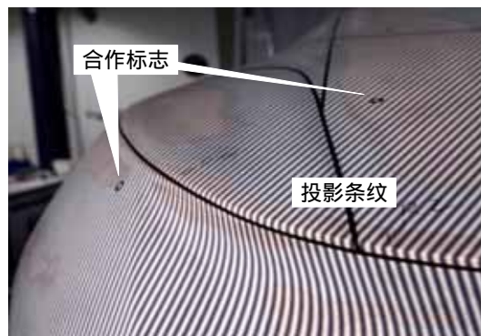
图 7.5.4 用于汽车外形测量的合作标志和投影条纹
